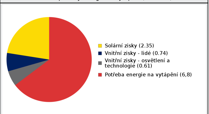
Bilance potřeby energie na vytápění (MWh/rok)
